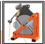
Soporte Placa térmica y Fresadora
