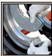
Reducciones Ø 90 ÷ 280mm master Ø 250 mm
