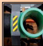
Mordaza rebajada para fijar las distintas geometrías de accesorios
