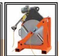
Soporte Placa térmica y Fresadora
